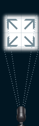
Narrow framing Max. Durchmesser 2,20m bei 5m Beleuchtungsdistanz
