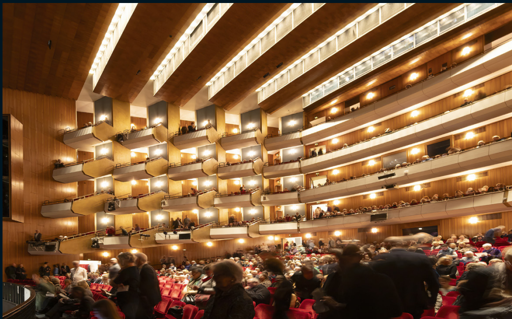
Hamburgische Staatsoper, Hamburg Für die Sanierung der Saalbeleuchtung setzte das Opernhaus auf maßgeschneiderte Atrium Doppelfokus-Downlights. Das Ergebnis: über 80% Energieeinsparung, exzellente Lichtqualität und hoher Sehkomfort. Lichtplanung: Ingenieurteam Gebäudetechnik GmbH & Co. KG Fotografie: Frieder Blickle
